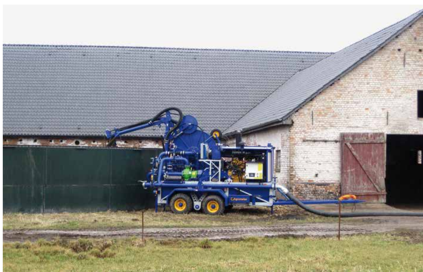
Pumpe 6 Zylinder Dieselmotor 120 PS
