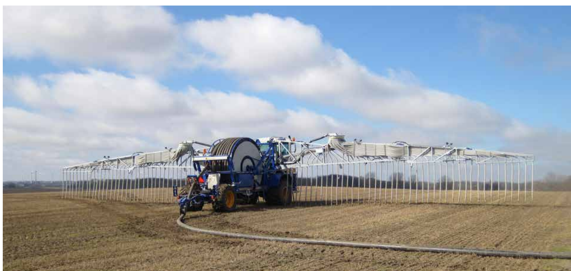
Agrometer mit 500 m Schlauchtrommel, 100 PS
