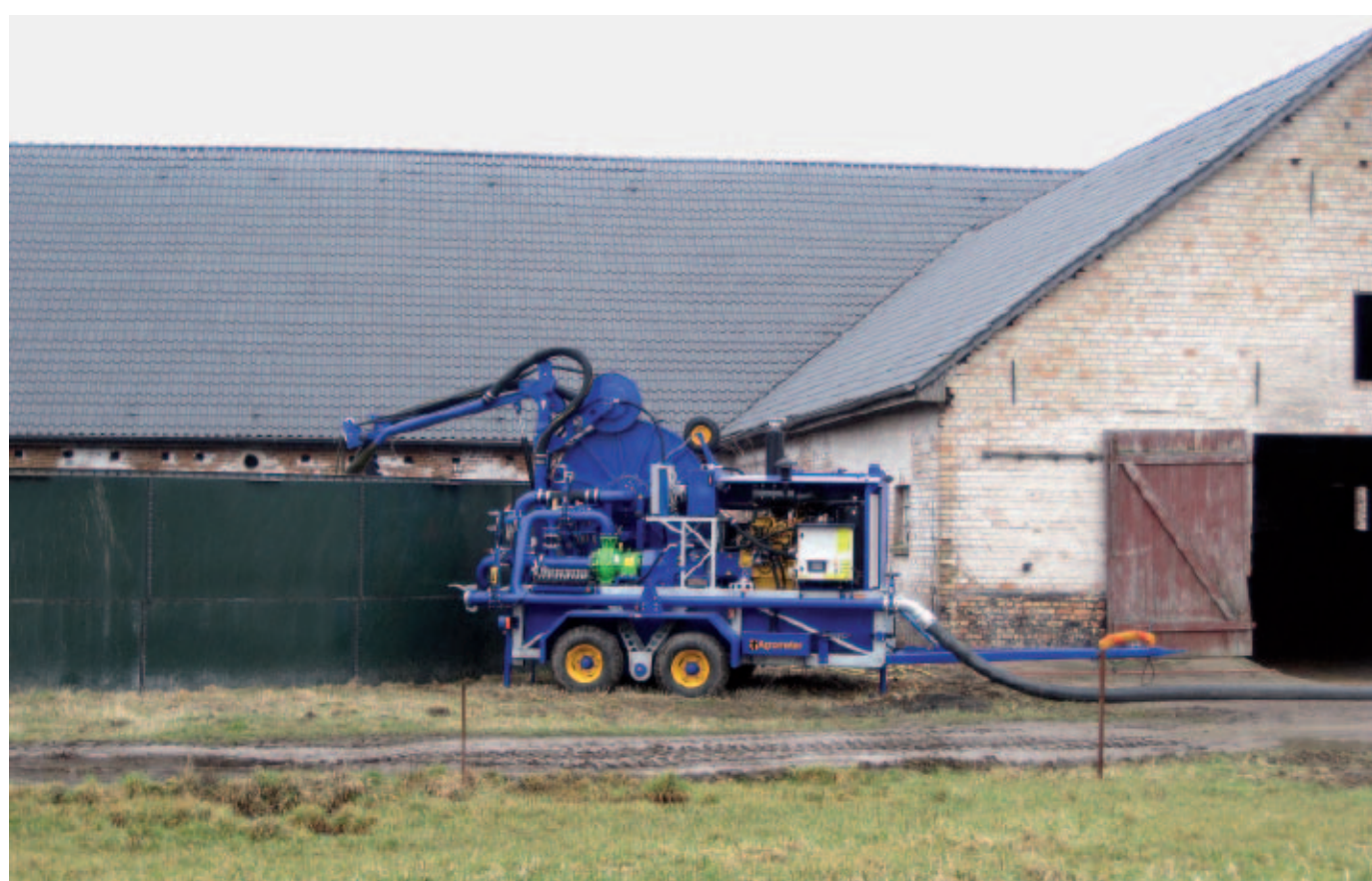
Pumpe 6 Zylinder Dieselmotor 120 PS
